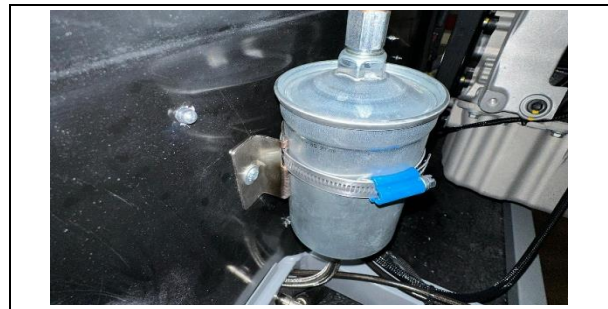
9AH) Support de filtre essence (version 2) Fuel filter's support (version 2)
