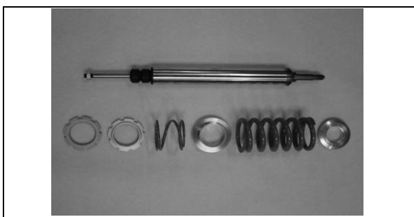
7AE) Amortisseur arrière démonté Rear dismounted shock absorber
