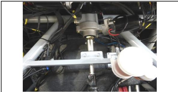
8AC) Direction assistée montée Power assisted steering mounted
