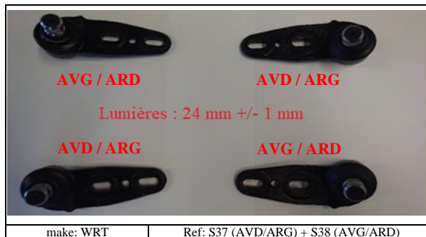
7AB) Cartouche d'amortisseur avant Front shock absorber
